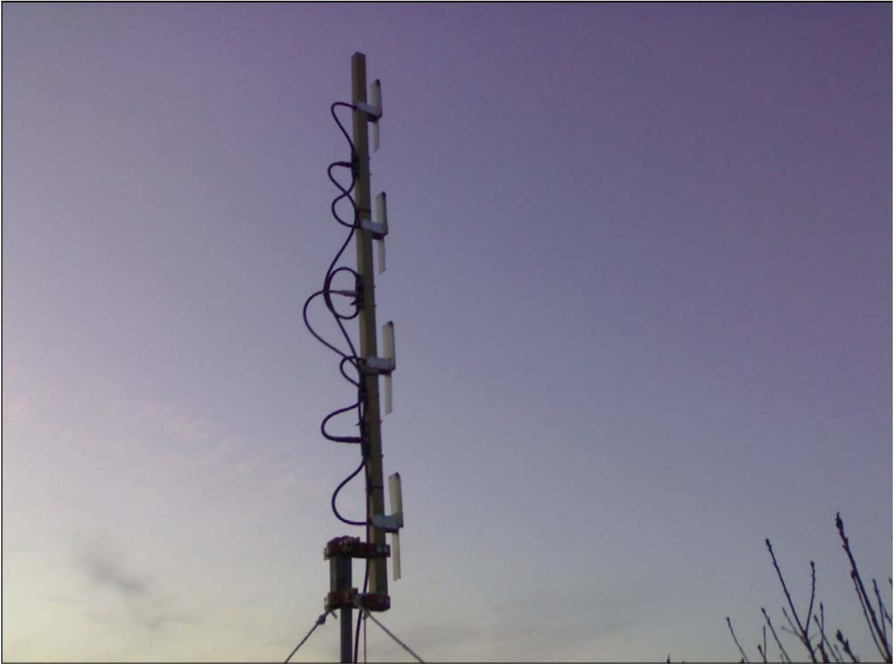
In questo breve articolo descriverò la realizzazione di un' antenna collineare a 4 dipoli ripiegati da 200 ohm messi in fase con linee di RG 214 sostenuti da un boom in alluminio 40x40 mm.
