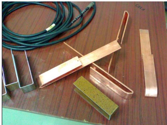
La sostituzione dei dipoli in alluminio con i dipoli in rame ci ha permesso di poter saldare direttamente il cavo RG 214 sugli stessi, eliminando non poche dispersioni (N maschio, N femmina da pannello e vite di accoppiamento, N pannello alluminio...).
